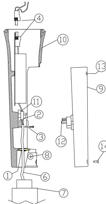
1. Munirsi di cavo bipolare della lunghezza del palo su cui verrà montato l'apparecchio e inserirlo attraverso il passacavo (1)
